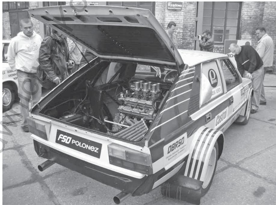
Widok wnętrza komory silnika Poloneza 2500 Racing
