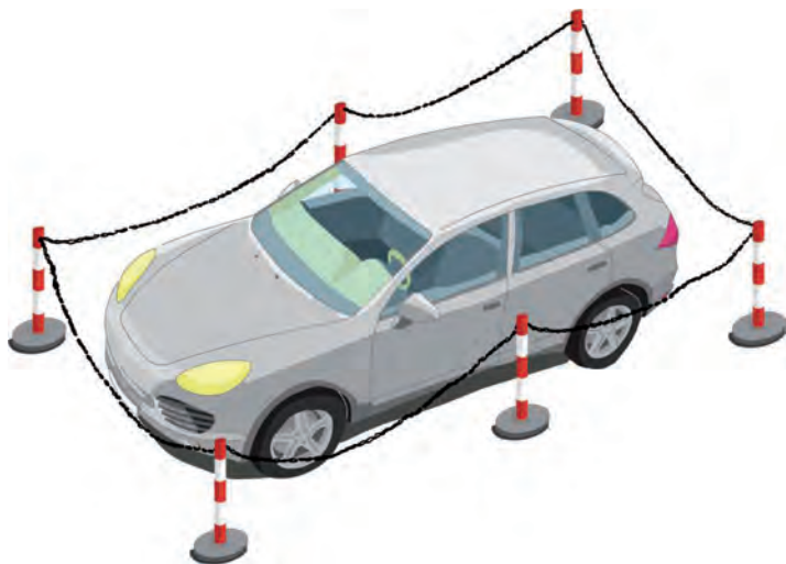
Rys. 3.54 Przykład zabezpieczenia samochodu hybrydowego na stanowisku naprawczym przed dostępem osób postronnych
