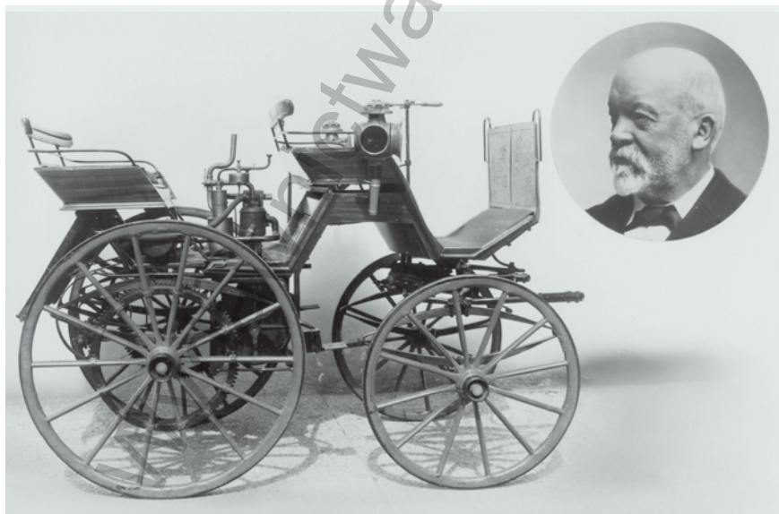
Czterokołowy, czterosobowy pojazd G. Daimlera z 1886 r., rozwijający prędkość 18 km/h, przebudowany z powozu konnego („Motorkutsche”)
