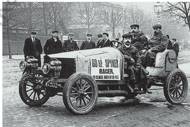
Samochód wyścigowy Spyker z 1902 r. z sześciocylindrowym silnikiem o pojemności skokowej 8676 cm 3 i mocy 60 KM, napędzającym obie osie
