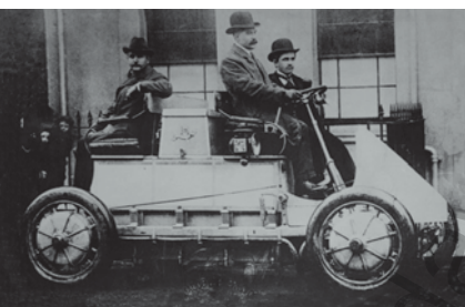
Pojazd elektryczny Lohner-Porsche z napędem wszystkich kół, zbudowany w 1900 r. na zamówienie angielskiego kierowcy wyścigowego E. W. Harta
