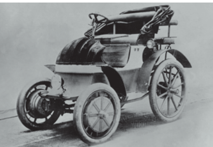
Pojazd elektryczny Lohner-Porsche z 1900 r. z napędem kół przednich przy użyciu dwóch silników umieszczonych w ich piastach, o mocy po 2,5 KM każdy
